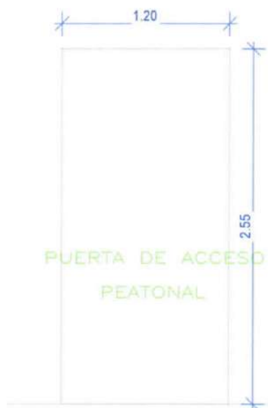
Vista de marco general de la puerta de acceso peatonal
