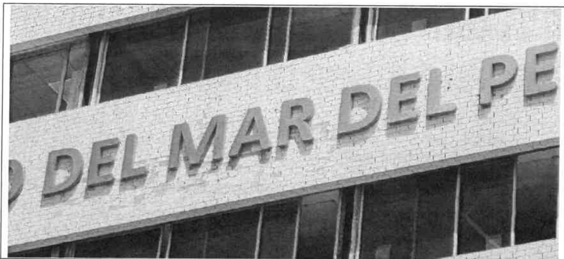
Imagen 2: Tipografía del letrero: Calibri. Altura: 0.80 m. Ancho de la frase incluyendo el logo: 19.00m. Corroborar mediante visita técnica.
