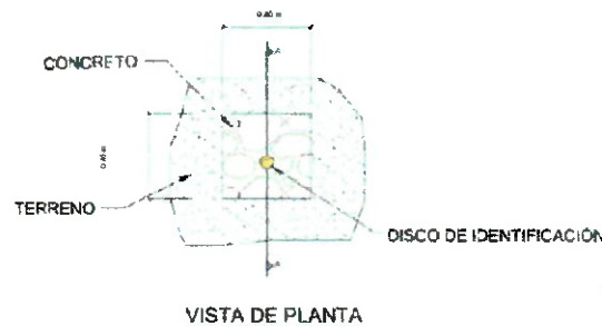
MEDIDAS DEL PILAR DE CONCRETO EN VISTAS DE PLANTA Y TRANSVERSAL
