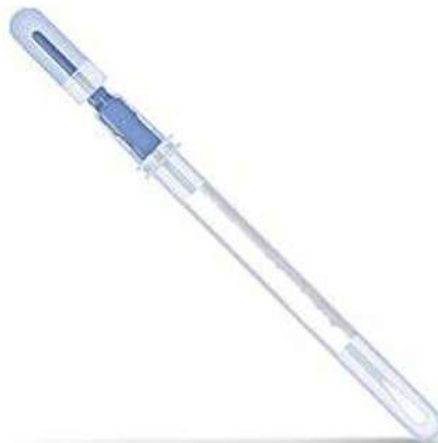
Fig.1: Hisopo integrado para control de higiene por bioluminiscencia (imagen referencial)
