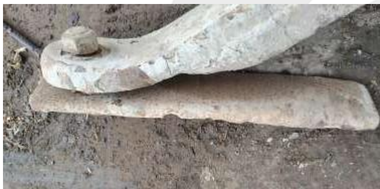
Imagen 3. Estado actual de las cuchillas de la Rotativa
