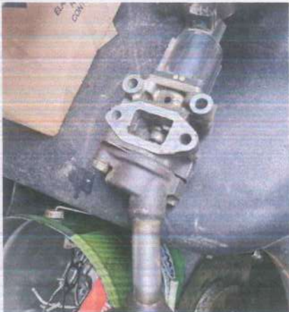
• IGR PARA MANTENIMIENTO
