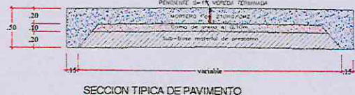
SECCION TIPICA DE PAVIMENTO Escala: 1:50
