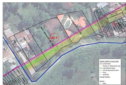
Figura N° 02: Área de intervención de trabajos de demolición de cercos y desbroce de plantaciones, limpieza en el Polígono 12 del PMD Aeropuerto Iquitos.
