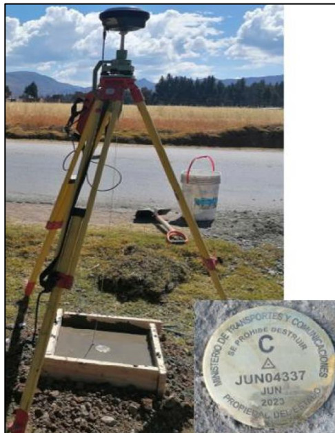
Imagen N°03. Imagen referencial de la Identificación del Punto Geodésico a instalar.
