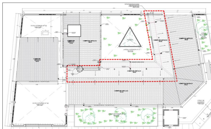
AREA DE INSTALACION DE ESTRUCTURA METALICA PARA COBERTURA
