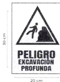
Imagen 01: ítem D – EXCAVACIÓN PROFUNDA
