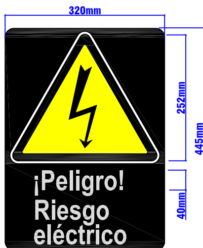
SEÑAL DE RIESGO ELECTRICO
