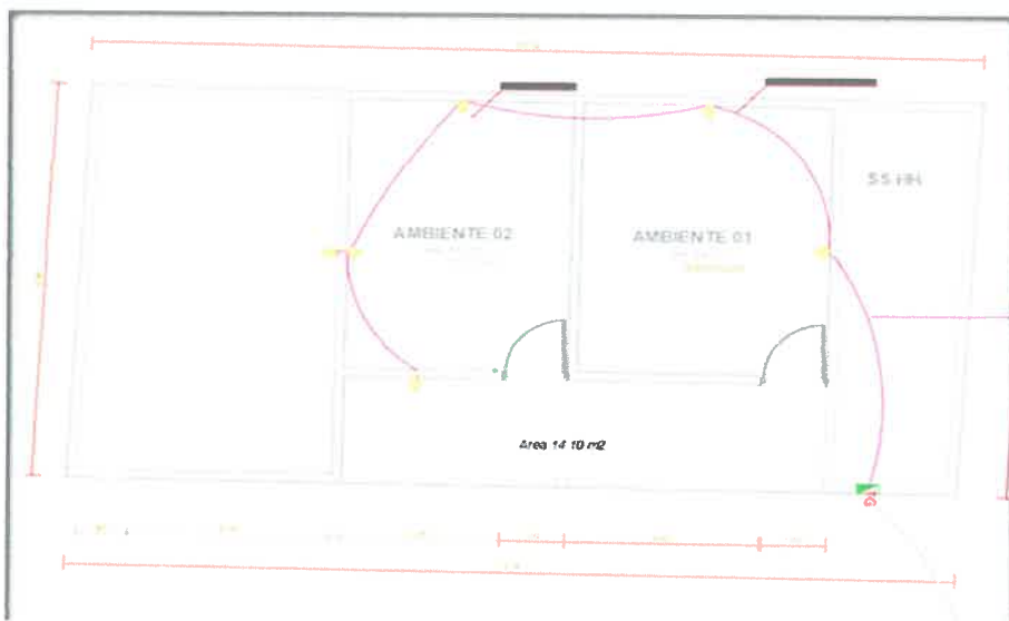
Imagen 09. Instalación eléctrica primer nivel-tomacorrientes.
