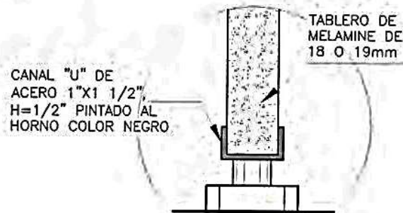
DETALLE C REGATÓN ESC: 1/2
