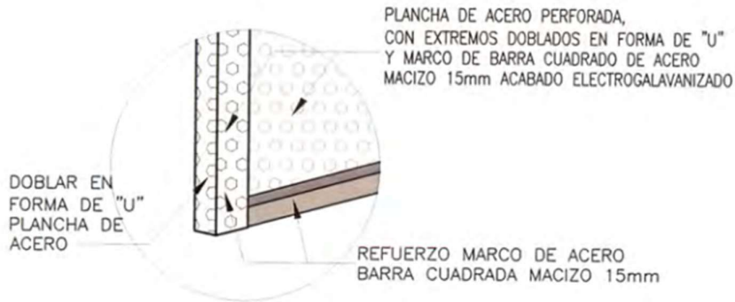
DETALLE B DOBLEZ ESC: 1/5
