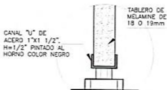
DETALLE C REGATÓN ESC: 1/2
