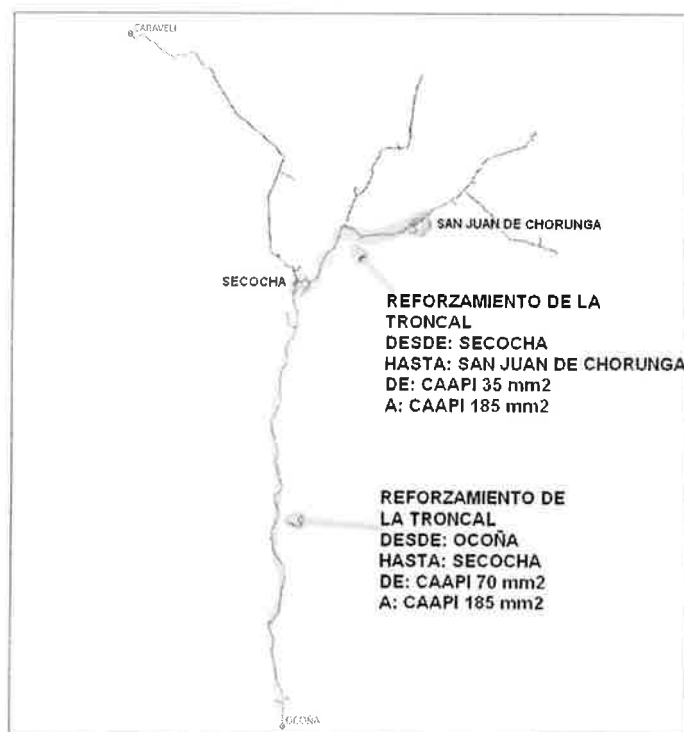
Reforzamiento de conductor en el AMT Rio Grande 4502
