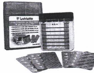
Imagen 2. Comparador colorimétrico visual para cloro libre
