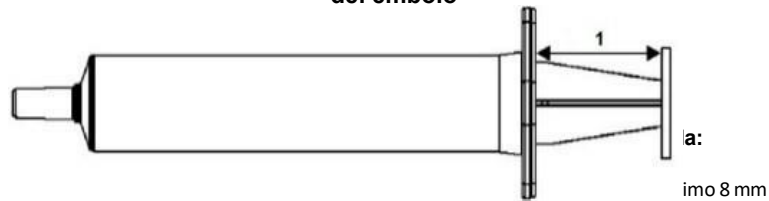
Figura referencial N° 3: Longitud mínima entre las alas de sujeción del cilindro y el disco de empuje del émbolo
